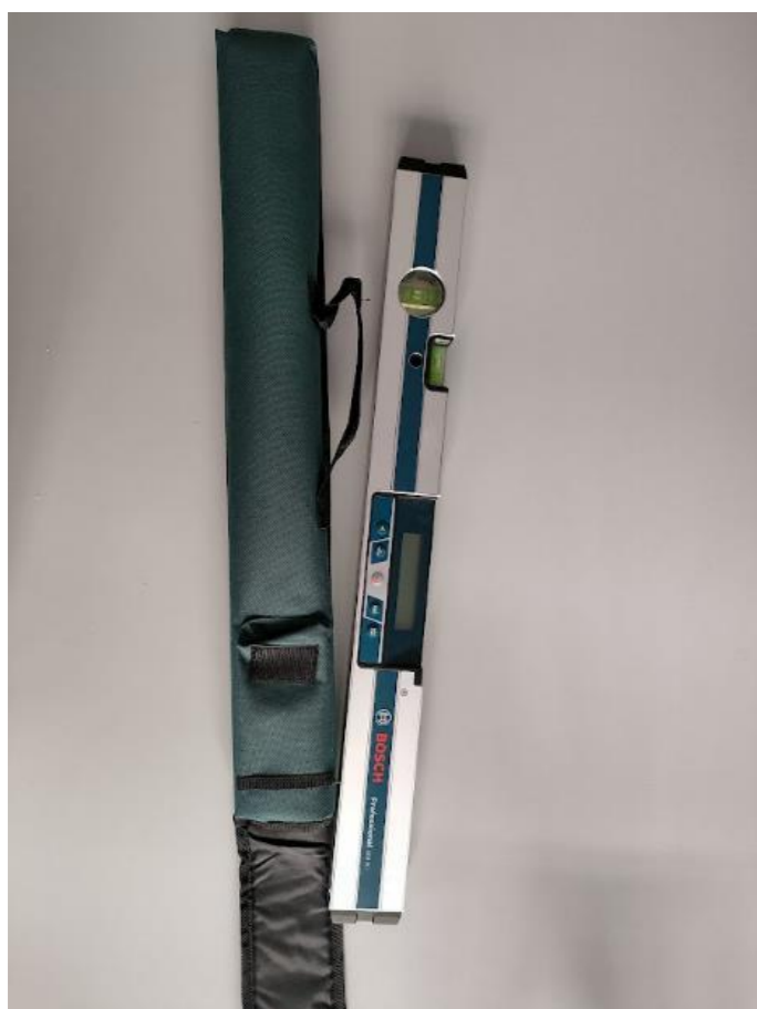
Figura 5: La livella elettronica utilizzata per i rilievi
